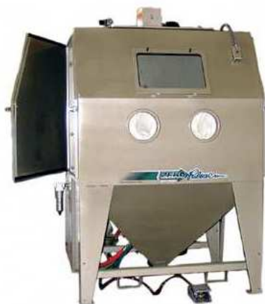
2.1.-4 pav. Mobilusis (rankinis) šratasraučio įrenginys
