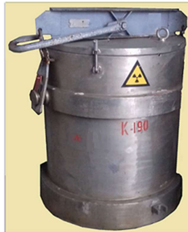
3.1-5 paveikslėlis. Bendras konteinerių K-150 ir K-190 vaizdas
