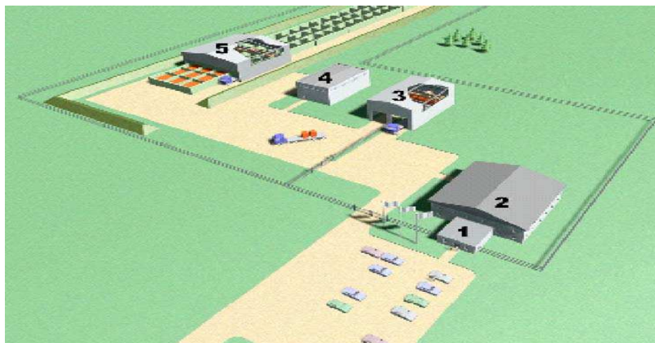
S.2. pav. Planuojamo paviršinio kapinyno konceptualus planas (rengiant techninį projektą bus pritaikytas prie konkrečios aikštelės konfigūracijos): 1 – įėjimas, apsaugos postas; 2 – administracija, centrinis valdymo pultas ir laboratorija; 3 – radioaktyviųjų atliekų pakuočių laikinoji saugykla; 4 – aptarnavimo sistemų ir įrenginių pastatas; 5 – radioaktyviųjų atliekų laidojimo rūšiai ir laikinasis stogas.
