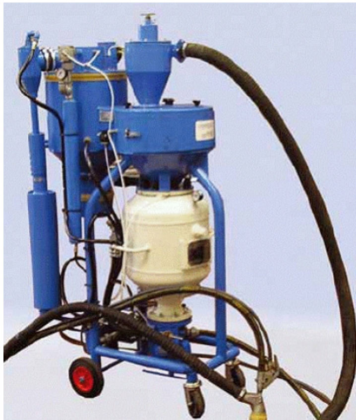
2.2.2-4 pav. Tipinis vakuuminio srautinio valymo įrenginys
