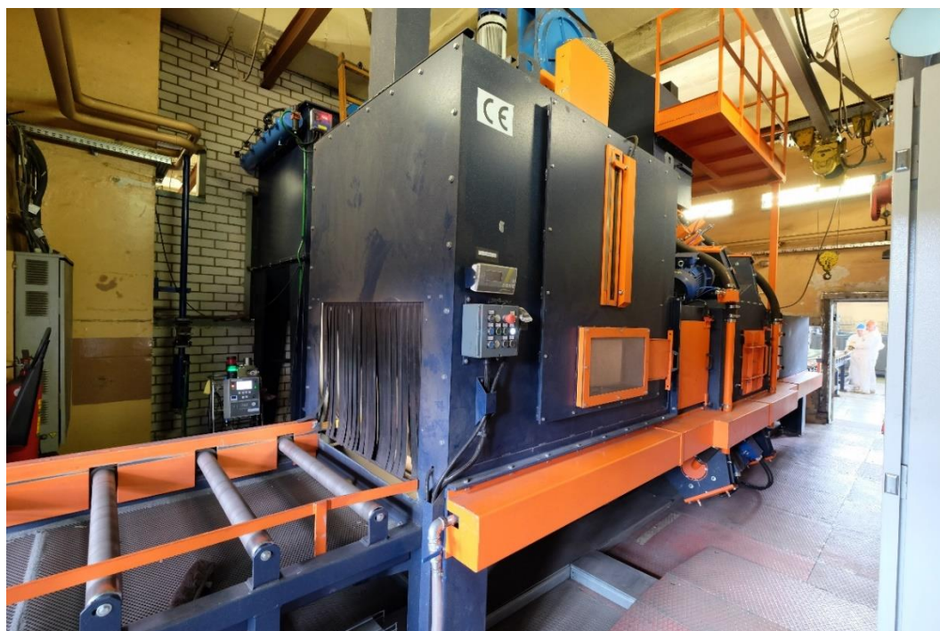
2.3-8 pav. Šratasvaidžio įrenginys su ritininiu konvejeriu 130/2 pastato dezaktyvavimo bare
