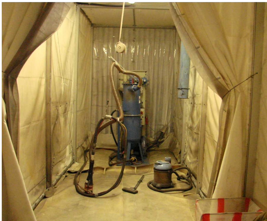
2.1.-7 pav. „ABRACLEAN LTD“ gamybos sauso šratasraučio dezaktyvavimo įrenginys BNR3S
