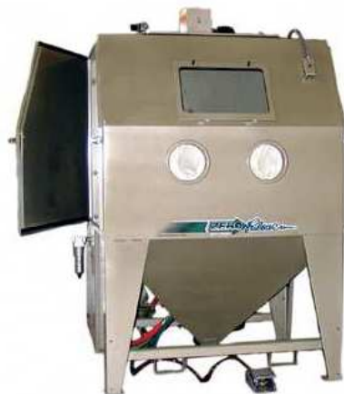
2.1.-4 pav. Mobilusis (rankinis) šratasraučio įrenginys
