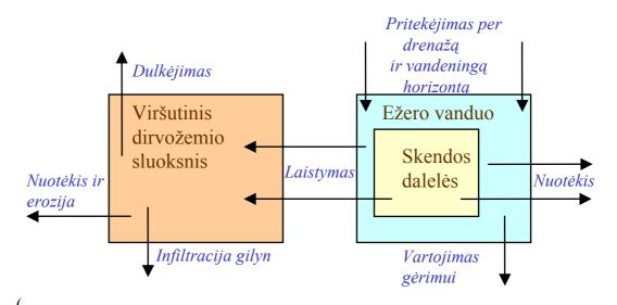
Pritekėjimas per drenažą ir vandeningą horizontą – inflow through drainage and aquifer;
