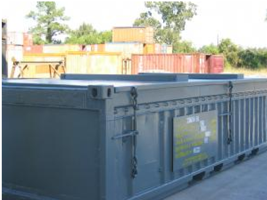
Рис. 2.2. 20-футовый полуконтейнер ISO со съемной стальной крышкой
