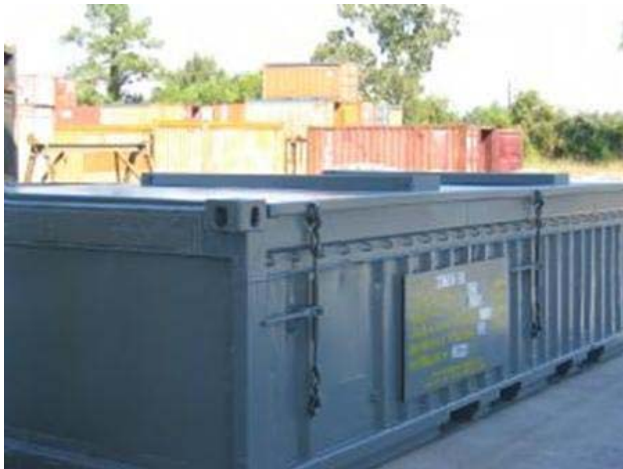
Рис. 3.6. 20-футовый полуконтейнер ISO со съемной стальной крышкой
