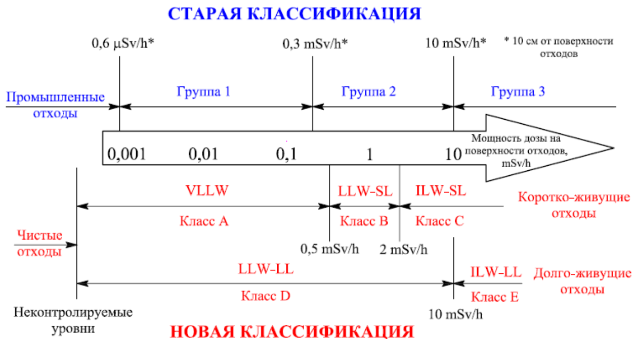
Рис. 1.2. Сравнение старой и новой классификации отходов. Не включены отработавшие закрытые источники (класс F по новой классификации)
