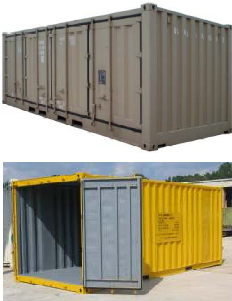
Рис. 2.3. Варианты 20-футового контейнера ISO с полностью открываемой боковой стороной и с дверью в торце
