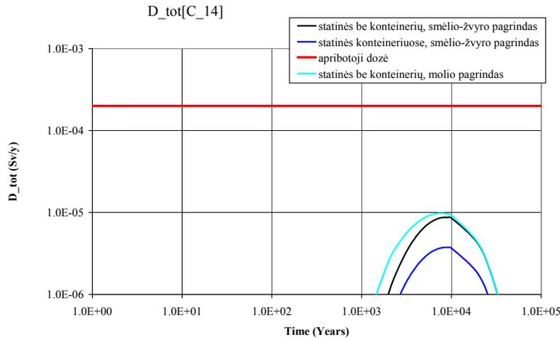
(statinės be konteinerių; smėlio-žvyro pagrindas – casks without containers, with sand-gravel base;
