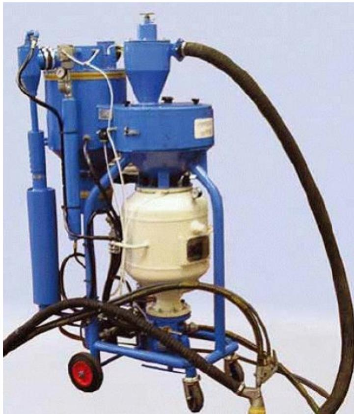
*Рис. 2.2.2-4. Типичная установка вакуумной струйной очистки*
