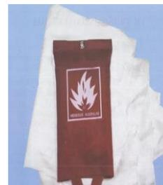
**Негорючая ткань** - предназначена для тушения людей и пожаров на небольшой площади. Негорючая ткань должна быть размером 0,9 x 1,8 м. Тушение производится путем набрасывания её на человека или на очаг пожара таким образом, чтобы изолировать поступление кислорода воздуха к очагу пожара (или месту горения на человеке)
