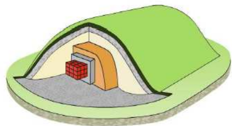
1.3-8 pav. Paviršinio atliekyno konceptualusis vaizdas, atliekų krovimo schema
