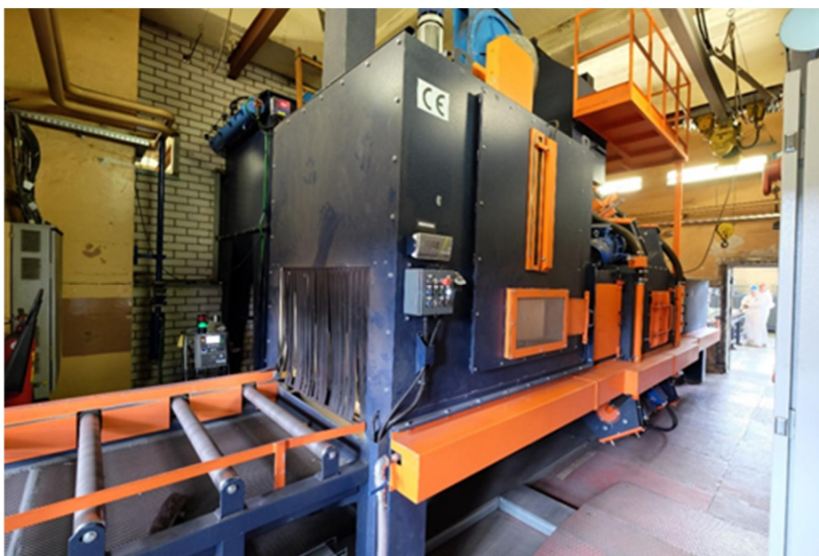
Pav. 2.1-5 Šratasvaidžio įrenginys su ritininiu konvejeriu 130/2 pastato dezaktyvavimo bare.
