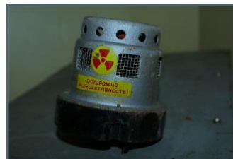
Cs-137: ЭМ type used in relays ГР-6, ГР-7 ir ГР-8
