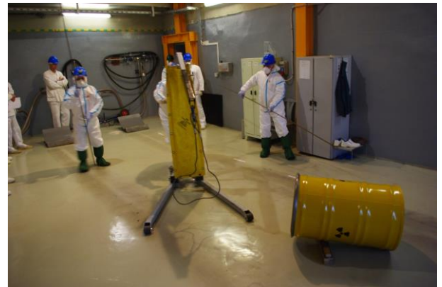
5.10.2-2 pav. Ruošiama įranga statinės pakėlimui į vertikalią padėtį.
