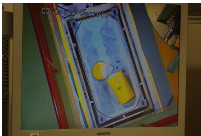
5.10.2-6 pav. Į konteinerį nukritusios statinės vaizdas cementavimo įrenginio krano valdymo monitoriuje
