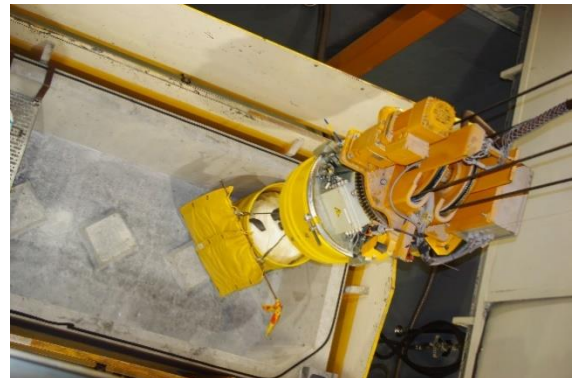
5.10.2-8 pav. Statinės pakėlimas į vertikalų padėtį, grafito surinkimas
