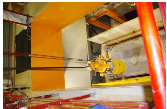
5.10.2-9 pav. Statinės transportavimas į pakuočių su grafitu kaupimo punktą
