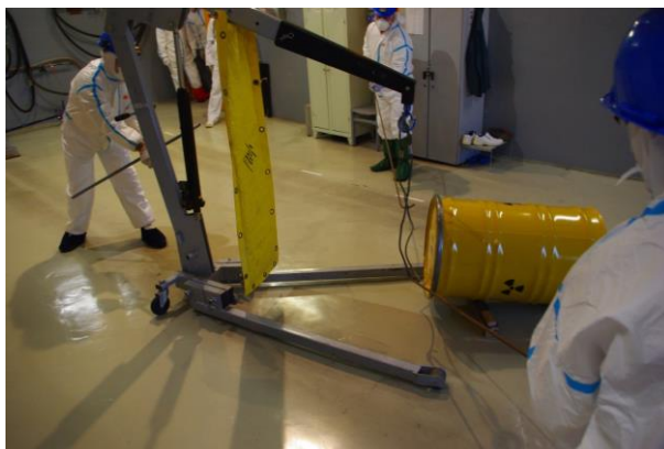
5.10.2-3 pav. Statinės pakėlimas į vertikalią padėtį.
