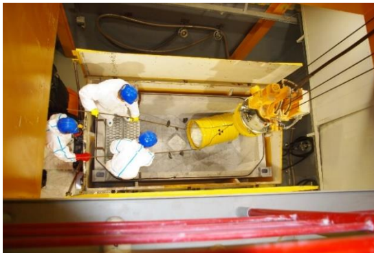
5.10.2-7 pav. Ruošiama įranga statinės pakėlimui į vertikalų padėtį
