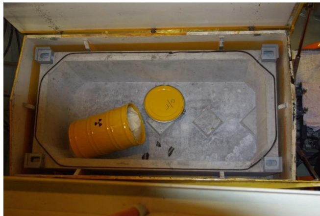
5.10.2-5 pav. 200 litrų statinė (pirminė pakuotė) su grafito atliekomis ir išsibarsčiusiais grafito gabalais po kritimo
